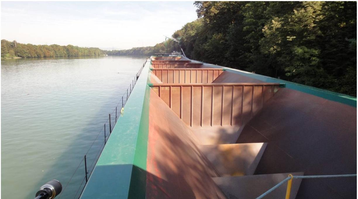
Die diversen Transportsilos, der Kapitän bestimmt die Löschung der Ladung aus Gründen der Sicherheit (Belastung des Schiffes)
